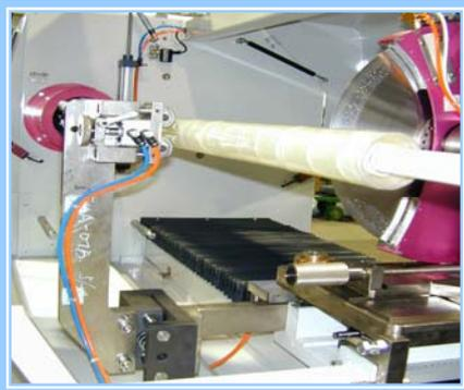
3"管心氣壓切割軸, 配 PU 管
